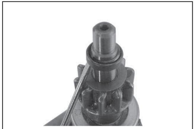
**Figure 8-61. Installation du collier d'arrêt et du dispositif de fixation.**
