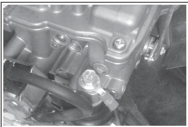
Figure 11-77. Câble de terre sur la vis de montage du carburateur (carburateur monocylindre).
