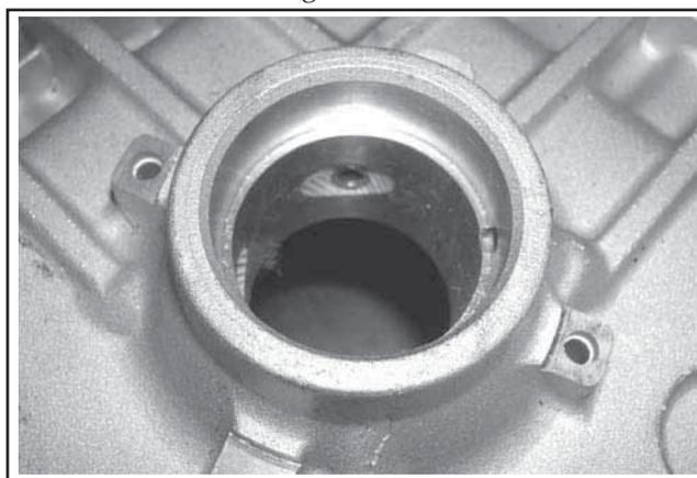
Figure 11-1. Trou du joint d'étanchéité du carter moteur.
