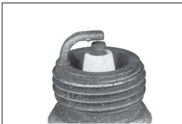
**Surchauffée :** Des dépôts calcaires blancs indiquent des températures de combustion très élevées. Cette situation est généralement accompagnée d'une érosion excessive de l'écartement. Des réglages pauvres du carburateur, une fuite au niveau de l'admission d'air ou un calage incorrect sont les causes les plus communes des températures de combustion élevées.
