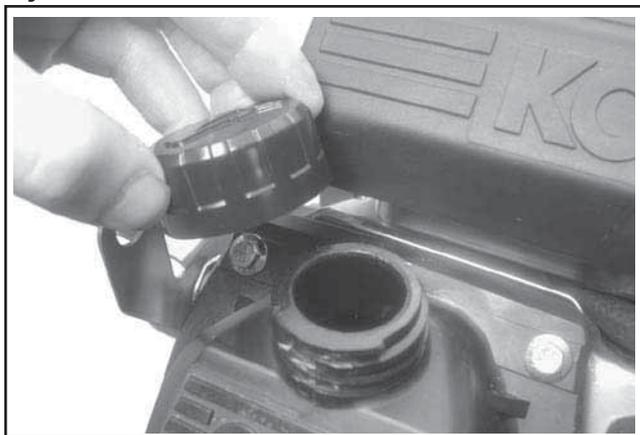
Figure 9-3. Enlèvement du bouchon de remplissage d'huile du couvercle.
