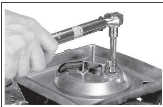
Figure 11-94. Serrage des vis de base.
