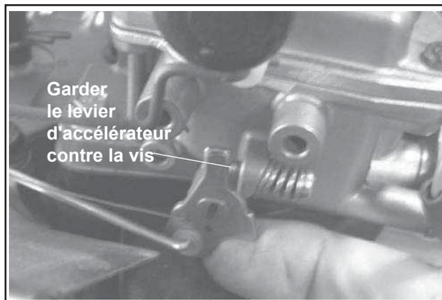
Figure 5-8. Placer le levier d'accélérateur contre la vis de blocage du ralenti (Carburateur monocylindre).
