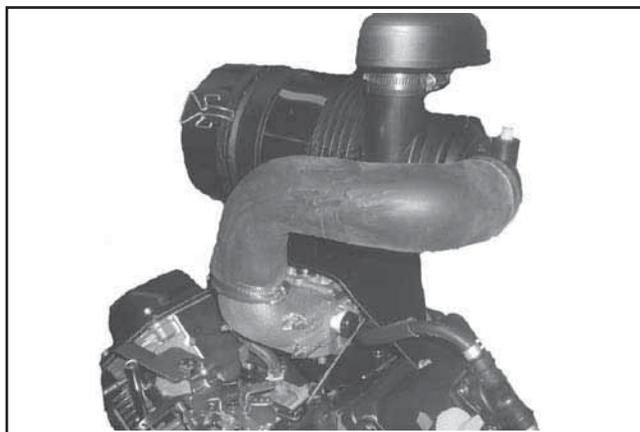
Figure 11-98. Filtre à air heavy-duty monté (carburateur bicylindre).
