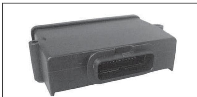
Figure 5B-2. Unité de contrôle ECU « 24 broches » (MSE 1.0) avec carter en plastique.
