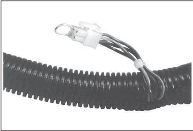
**Figure 5B-8. Connecteur services, câblage de l'unité de contrôle ECU avec carter en métal.**
