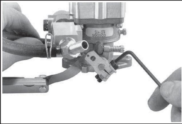
**Figure 5A-10. Serrage de la vis de montage du régime du ralenti.**
