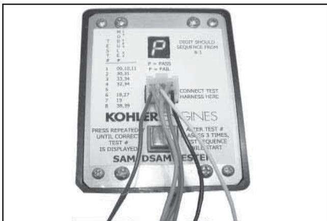
Figure 8-15. Sélectionner le numéro d'essai.
