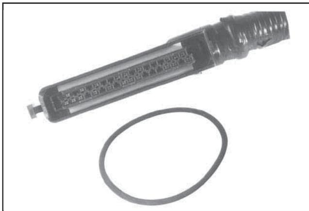
**Figure 5B-23. Connecteur et joint torique d'étanchéité unité de contrôle ECU « 35 broches » (MA 1.7) avec carter en métal.**
