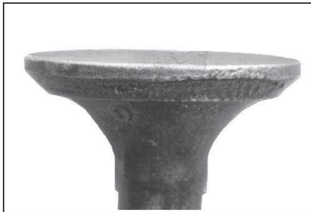
**Fuites :** Un meulage pauvre sur le collet ou le siège des soupapes engendre des fuites, résultant en une soupape brûlée d'un seul côté.
