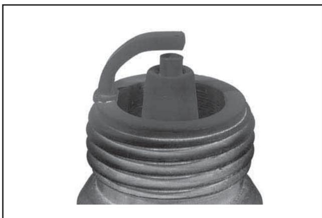
**Dépôts de charbon :** Des dépôts souples, noirs et fuligineux indiquent une combustion incomplète due à un filtre à air sale, un mélange de carburant trop riche, un allumage faible ou une compression de mauvaise qualité.
