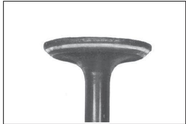
**Surchauffée :** Une soupape d'échappement soumise à une surchauffe est plus foncée dans la zone au-dessus du guide de soupape. Des guides usés et des ressorts de soupape défectueux peuvent être à l'origine de la surchauffe. Lorsqu'on remarque cette condition, contrôler également que la conduite d'air n'est pas bouchée et que les ailettes ne sont pas bloquées.
