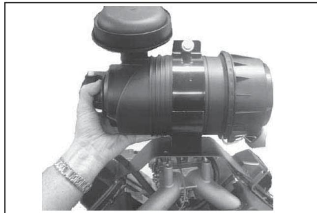
Figure 9-14. Enlèvement du groupe du filtre à air heavy-duty (modèle bicylindre ci-représenté).
