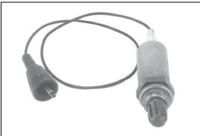
Figure 5B-11. Capteur d'oxygène.
