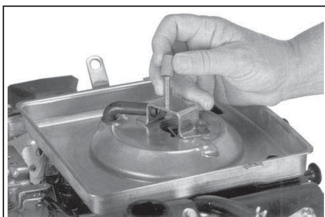
Figure 4-7. Enlèvement du joint en caoutchouc de la bride.
