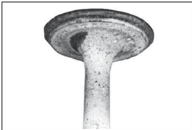
**Normale :** Même après de longues heures de fonctionnement, une soupape peut être rectifiée et réutilisée si le collet et la marge sont encore en bon état. Si la soupape est usée à une marge inférieure à 1/32 de pouce, ne pas la réutiliser. La soupape montrée ici a été en service pendant presque 1 000 heures dans des conditions de test contrôlées.
