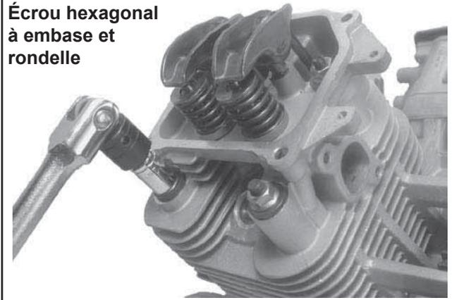
Figure 9-51. Enlèvement des raccords des culasses des cylindres.
