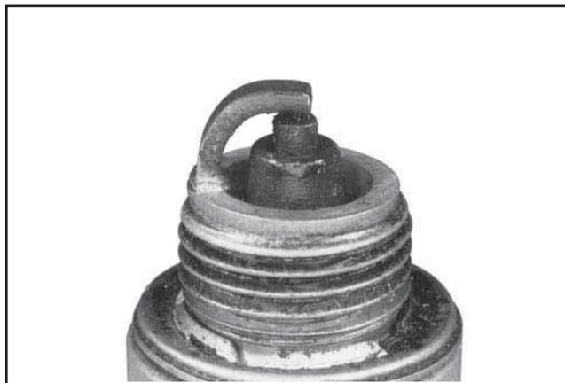
**Sale et humide :** Une bougie humide est due à un excès de carburant ou d'huile dans la chambre de combustion. L'excès de carburant peut être dû au colmatage du filtre à air, à un problème au carburateur ou à un fonctionnement du moteur la vanne d'air trop ouverte. La présence d'huile dans la chambre de combustion est généralement due au colmatage du filtre à air, à un problème au reniflard ou à des segments ou des guides soupapes usés.
