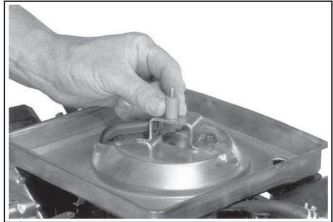
Figure 9-8. Enlèvement du dispositif de fixation de la base du filtre à air.
