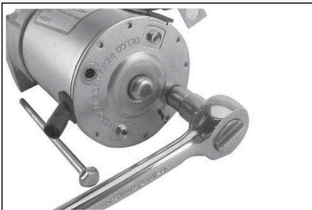
Figure 8-48. Enlèvement des boulons traversants.
