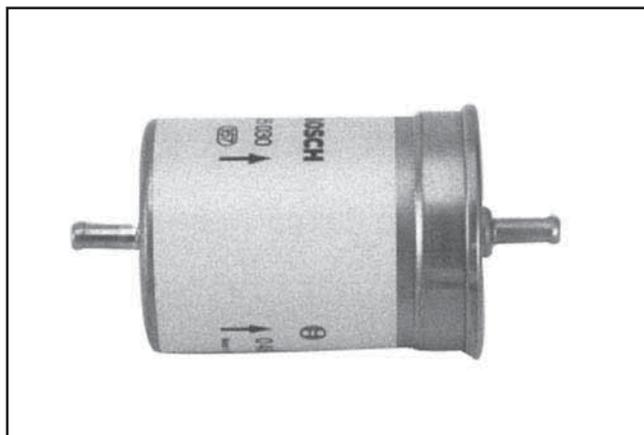
Figure 5B-32. Filtre à carburant en ligne.
