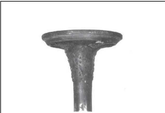
**Caoutchouc :** Les dépôts de caoutchouc sont généralement dus à une essence viciée. Le caoutchouc est l'une des causes principales d'adhérence des soupapes. La solution consiste à fraiser les guides de soupapes et à nettoyer ou remplacer les soupapes en fonction de leur état.
