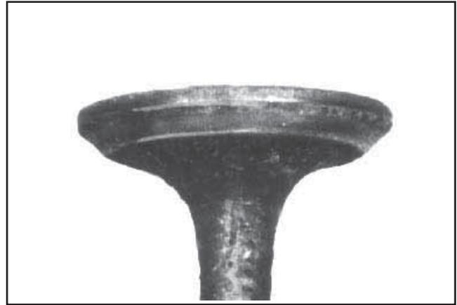
**Corrosion des tiges :** L'humidité dans le carburant ou la condensation sont les causes les plus communes de corrosion des tiges des soupapes. La condensation vient d'une conservation incorrecte pendant le remisage et lorsque le moteur est arrêté plusieurs fois avant qu'il ait la possibilité d'atteindre des températures de service normales. Remplacer les soupapes corrodées.
