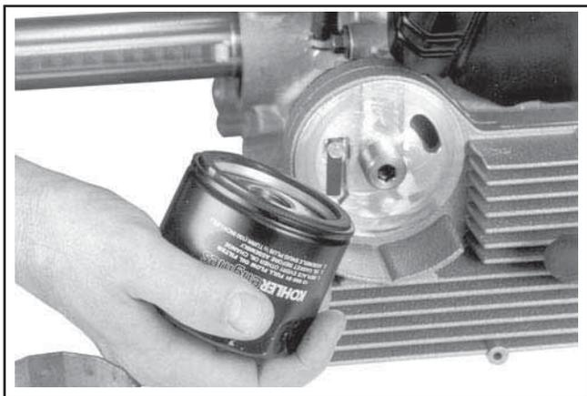
**Figure 11-101. Installation du nouveau filtre à huile.**
