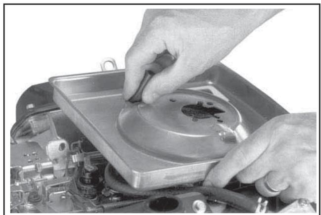
Figure 9-10. Enlèvement du tuyau d'évent de la base.
