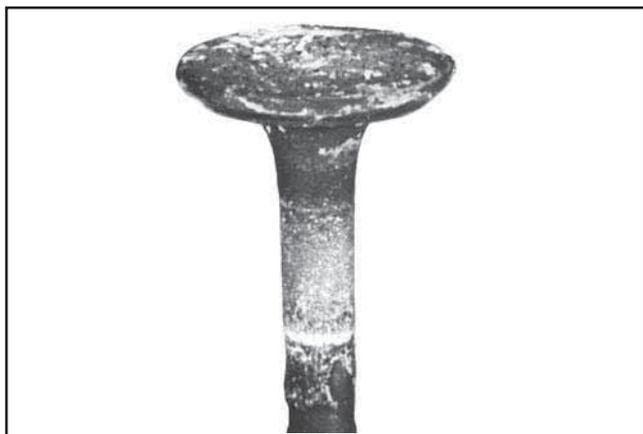
**Mauvais état :** La soupape représenté devrait être remplacée. Noter la culasse abîmée, la marge endommagée et trop étroite. Ces défauts peuvent être attribués à un fonctionnement trop intensif ou à de mauvaises conditions de fonctionnement.
