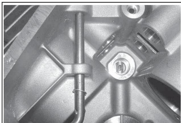
Figure 11-5. Installation du petit arbre transversal du régulateur de 8 mm.
